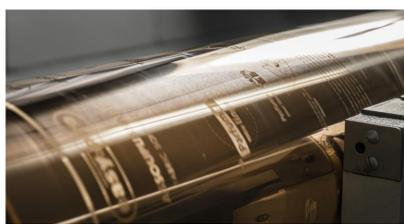
2 Grabado interno de cilindros y probadora de cilindros
